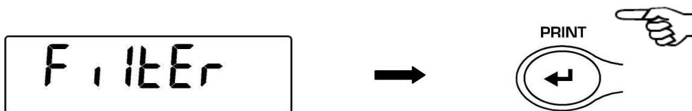
2. Durch Drücken der Taste **MENU** oder **CAL** ist es möglich, die verschiedenen Ebenen der Filterung vor- oder zurückzublätern. Wählen Sie die gewünschte aus und bestätigen Sie mit der Taste **PRINT**.
