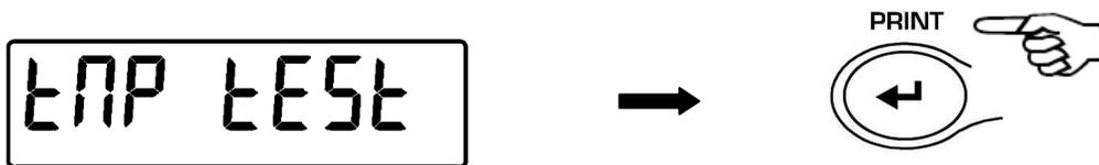
Bestätigen Sie mit der Taste PRINT die Testfunktion der Temperatur.
