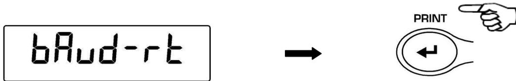
2. Wählen Sie die Geschwindigkeit der seriellen Datenübertragung (1200-2400-4800-9600 Baudrate) aus. Durch Drücken der Taste **MENU** oder **CAL** ist es möglich, die verschiedenen Übertragungsgeschwindigkeiten vor- oder zurückzublättern. Bestätigen Sie dann die Auswahl mit der Taste **PRINT**.
