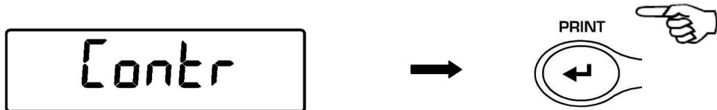
2. Durch Drücken der Taste **MENU** oder **CAL** ist es möglich, die Kontraststufe des Displays zu erhöhen oder zu reduzieren. Wählen Sie die gewünschte aus und bestätigen Sie mit der Taste **PRINT**
