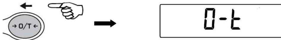
3. Nach Erreichen der Stabilität wird der Nullwert "**0.000**" angezeigt. Falls die Stabilität wegen Luftströmungen, Vibrationen oder anderen Störungen nicht erreicht wird, wird die Schrift "**O-t**" weiterhin angezeigt.
